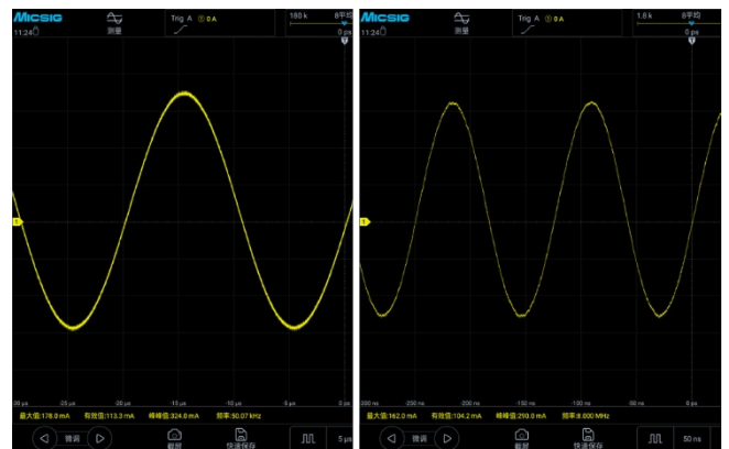
CP3008: Behält 92 % des ursprünglichen Stromwerts bei, wenn ein 113-mV-Signal von 50 kHz auf 8 MHz angepasst wird, und gewährleistet so Genauigkeit bei Hochfrequenzmessungen.
