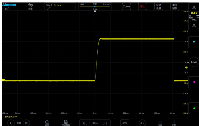
CP3008: Präzise Erfassung von Transienten bei Hochstromsignalen mit 400 A.
